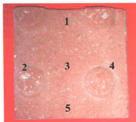
Figura 2.- Ubicación de los cinco puntos de la medida de la irradiación en las superficies de las probetas estudiadas.
